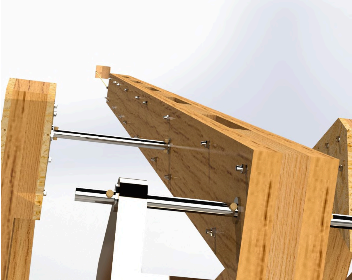
Figura 126: Detalles del brazo lanzador de la catapulta tipo trebuchet. Fuente: Elaboración propia.
