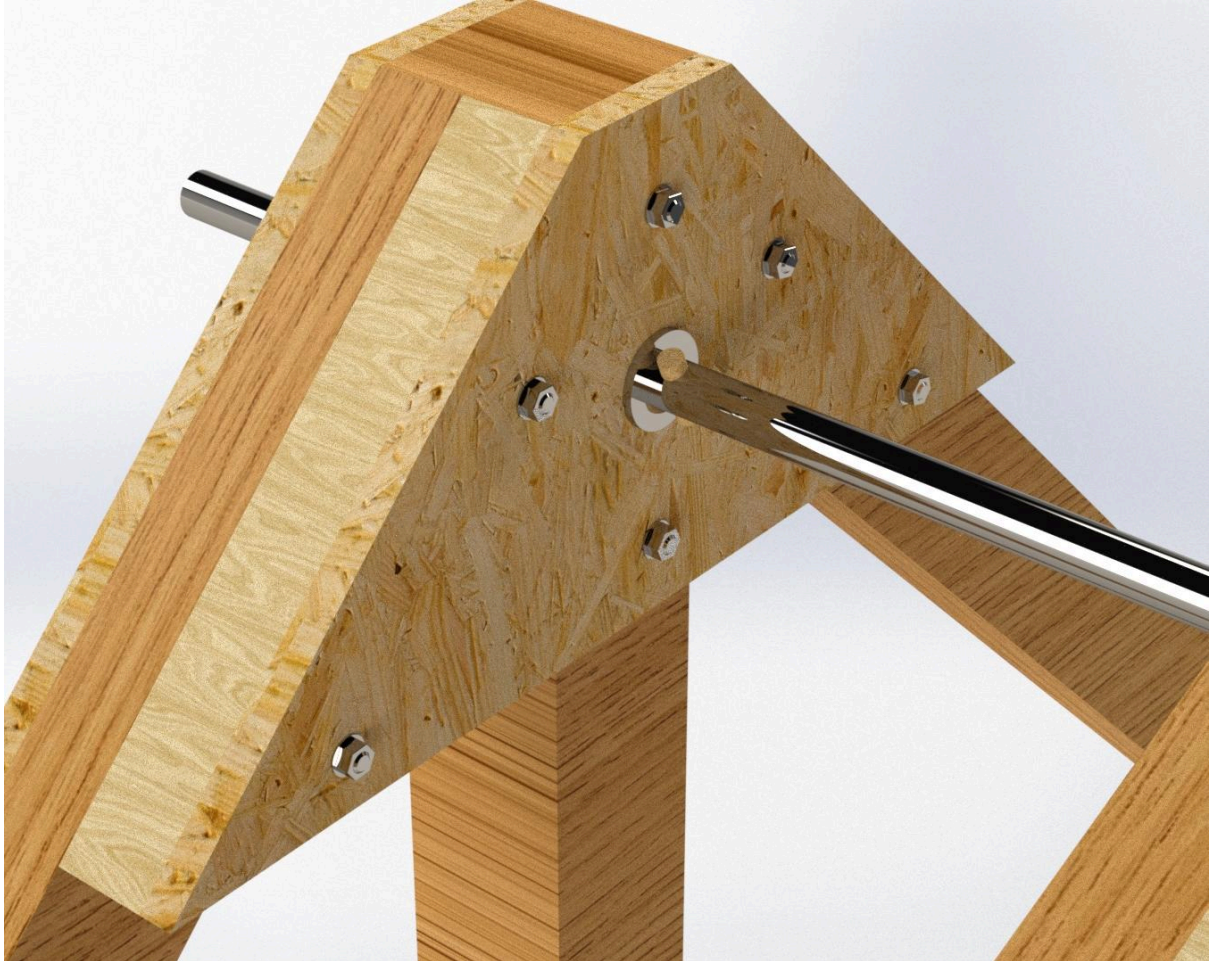
Figura 124: Detalle del marco superior de la catapulta tipo trebuchet. Fuente: Elaboración propia.
