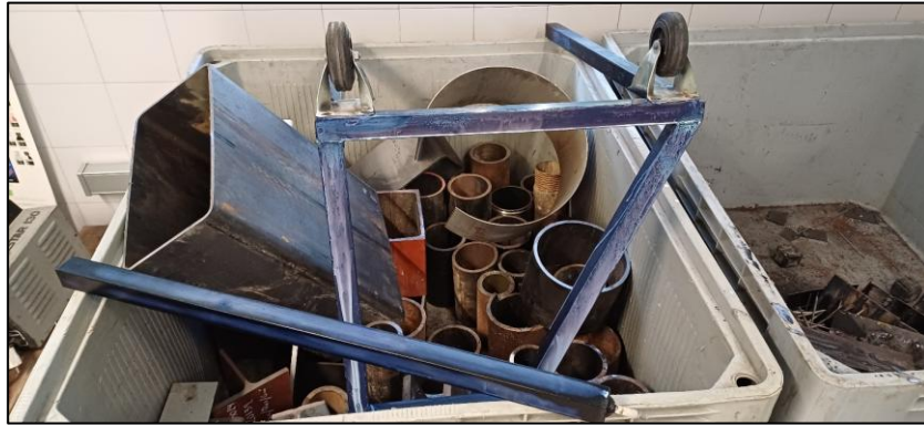
Figura 43. Estructura con convertidor de óxido aplicado.
