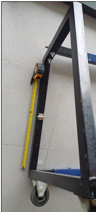
Figura 61. (a) Replanteo de pestillos, (b) Mecanizado de orificios.
