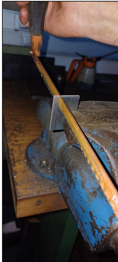
Figura 19. Proceso de corte manual de las pletinas.
