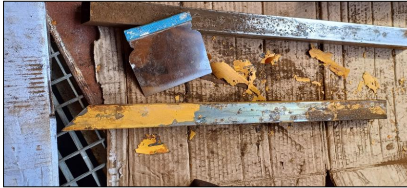
Figura 29. Oxido y pintura resultante de un perfil.
