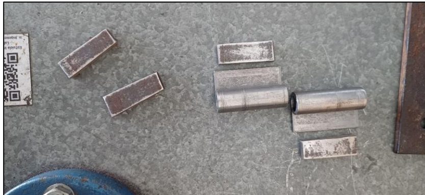
Figura 46. (a) Corte de pletinas con amoladora, (b) Lijado y limado, (c) Piezas preparadas para mecanizado.
