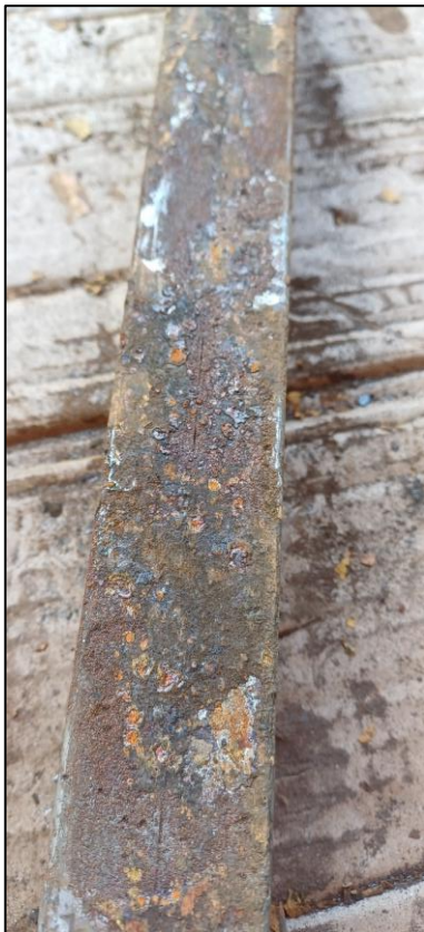
Figura 28. (a) Perfil oxidado, (b) Perfil tras varias pasadas de lija.
