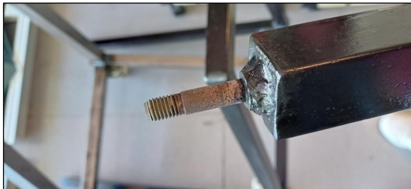
Figura 38. Eje derecho soldado.
