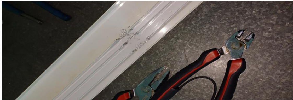
Figura 22. Mecanizado manual de las guías.
