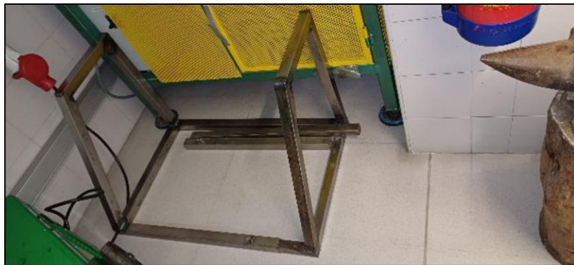
Figura 35. (a) Estructuras inferiores soldadas, (b) Estructura acoplada.
