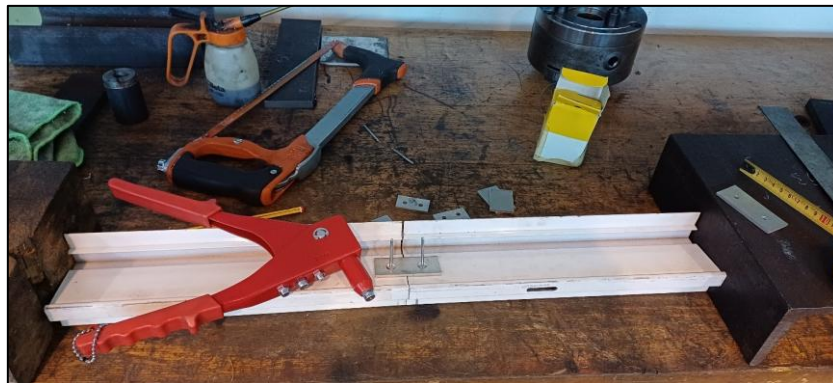
Figura 21. Unión de los perfiles con remaches.
