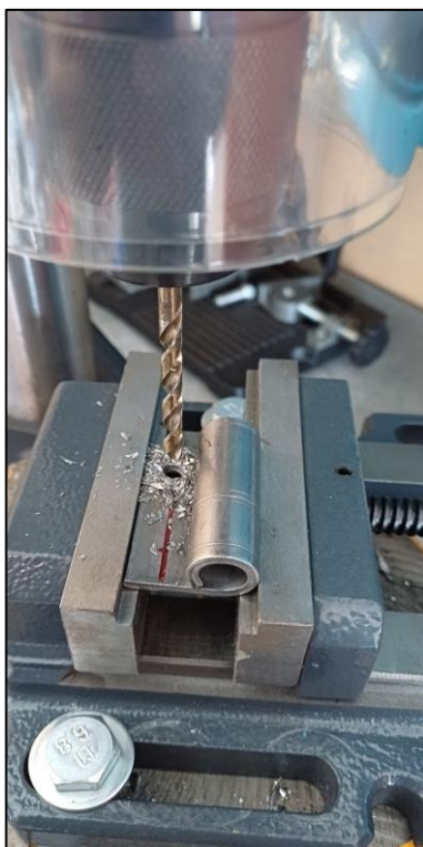
Figura 49. (a) Taladrado de las bisagras, (b) Taladrado de los suplementos.
