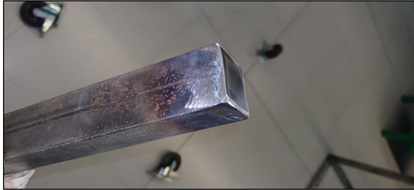
Figura 37. Desbaste de soldadura de la pletina.
