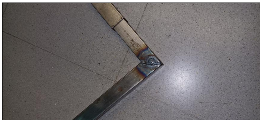
Figura 32. Rebaba generada en la unión.
