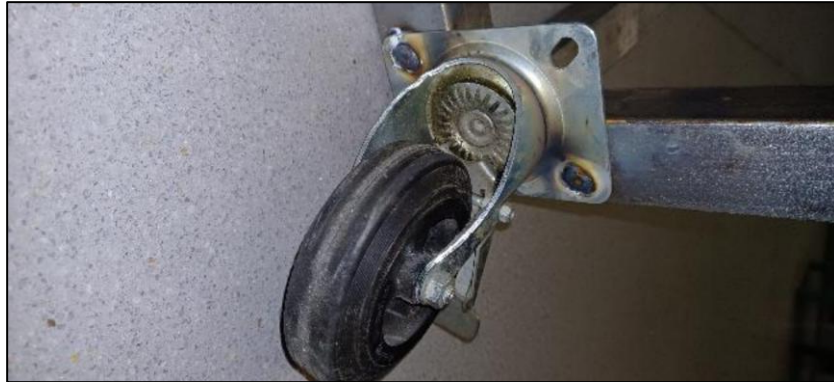
Figura 40. Rueda giratoria soldada.
