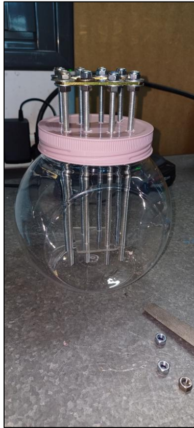
Figura 72. (a) Proceso de ensamblaje, (b) Electrolizador terminado.
