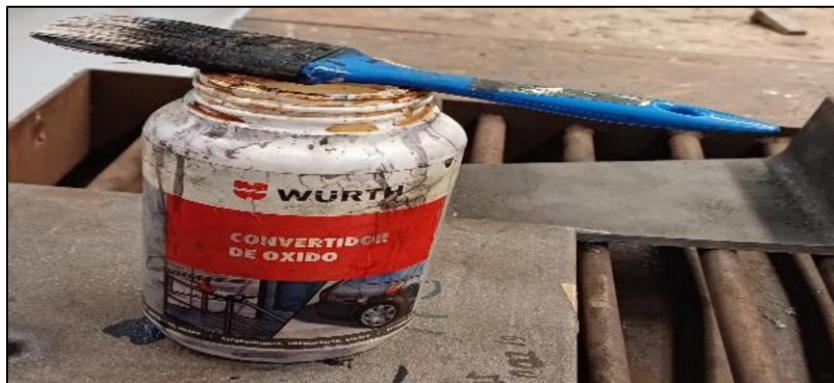
Figura 42. Convertidor de óxido utilizado.
