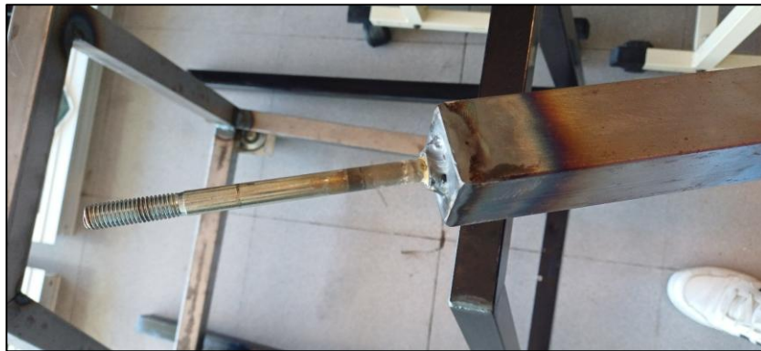
Figura 39. Eje derecho soldado.
