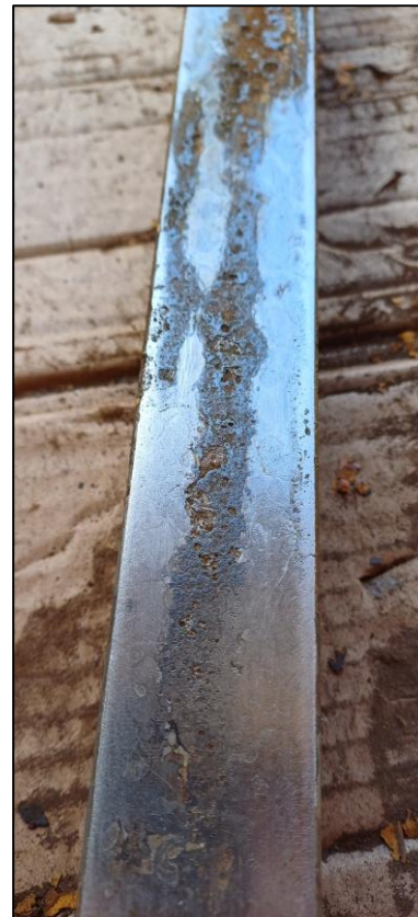
Figura 28. (a) Perfil oxidado, (b) Perfil tras varias pasadas de lija.
