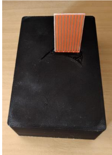
Figura 3.16. Hub con sensor lluvia
