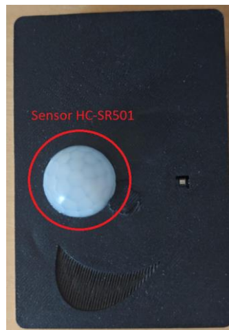
Figura 3.12. Hub con sensor HC-SR501
