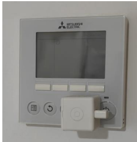
Figura 3.20. Tuya Fingerbot Pusher
