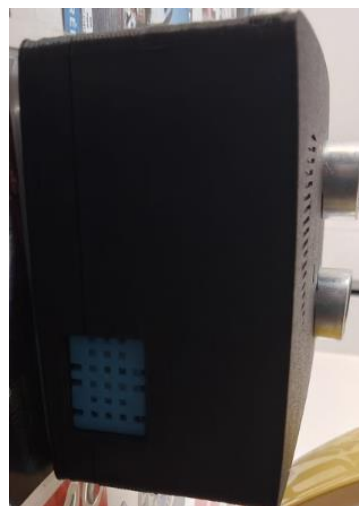
Figura 3.14. Hub con sensor DHT11
