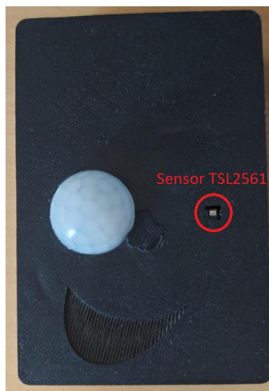
Figura 3.9. Hub con sensor TSL2561
