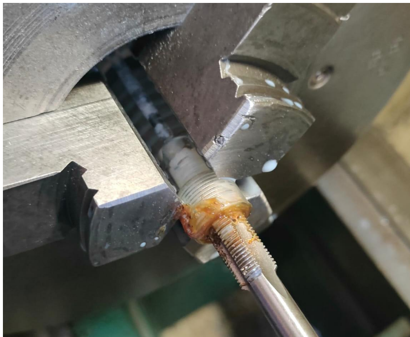
Figura 52. Roscado manual mediante machuelo de 1/8".
