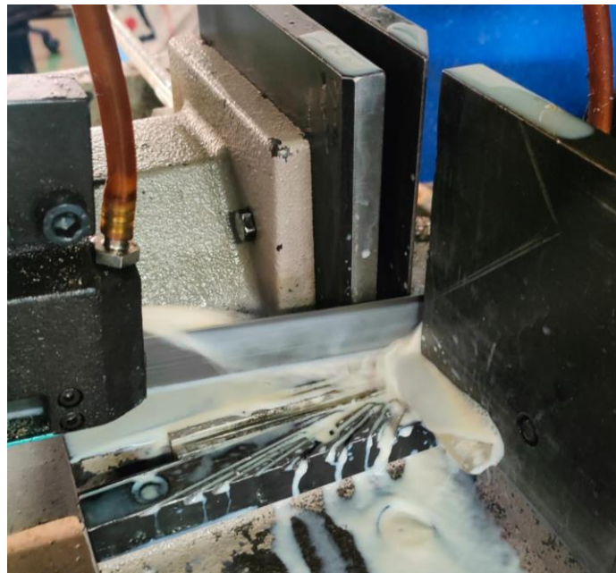
Figura 49. Recorte del cilindro de metacrilato mediante cinta automática.
