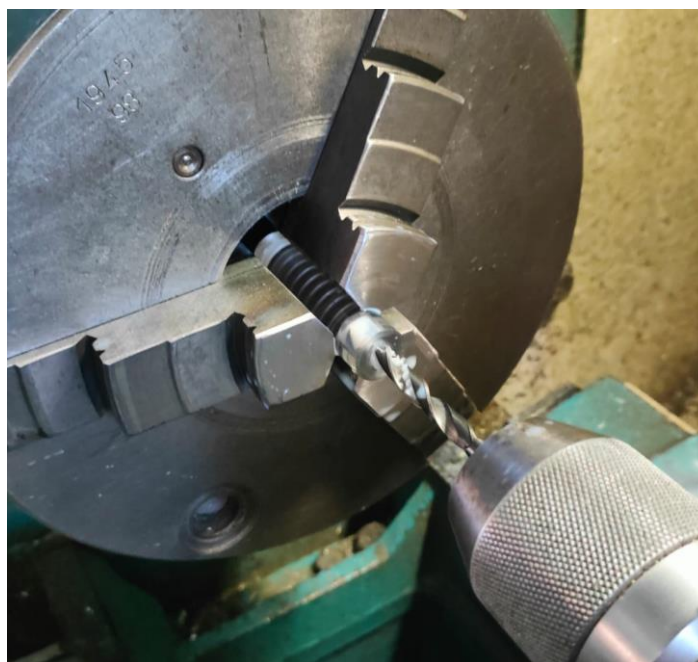
Figura 50. Taladrado mediante torno.
