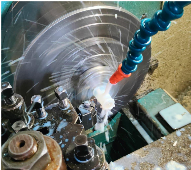
Figura 53. Reducción de diámetro exterior mediante torneado.
