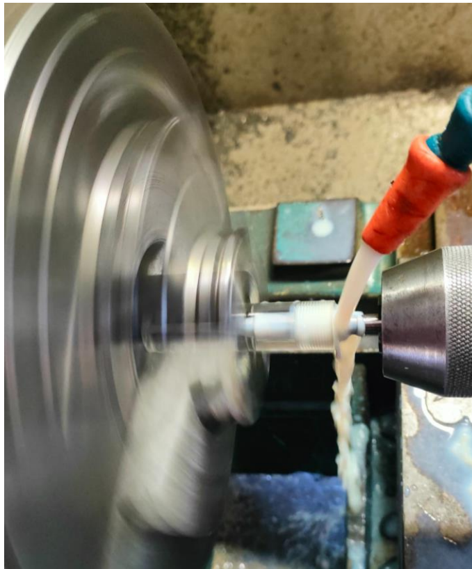
Figura 51. Taladro cónico mediante torno para conexión entre orificios.
