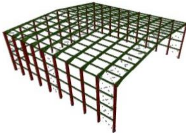
Figura 11. Modelado estructura CYPE 3D.
