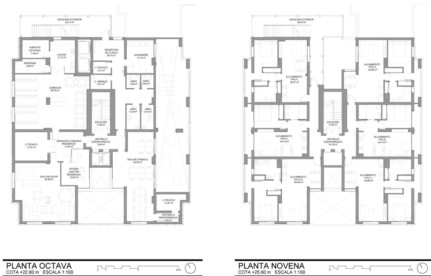
Figura 10. Propuesta de distribución de las plantas destinadas a los alojamientos de las familias en el edificio C/ Gabriel nº 27.
