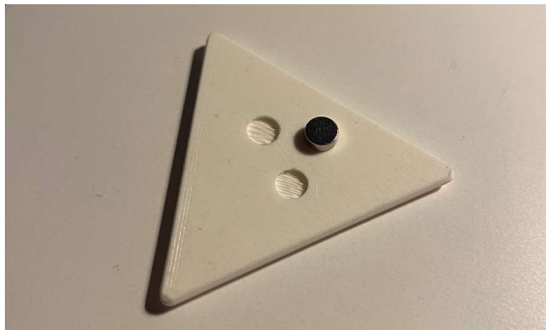
Figura 48. Prueba tolerancia para imán. (Elaboración propia, 2025)
