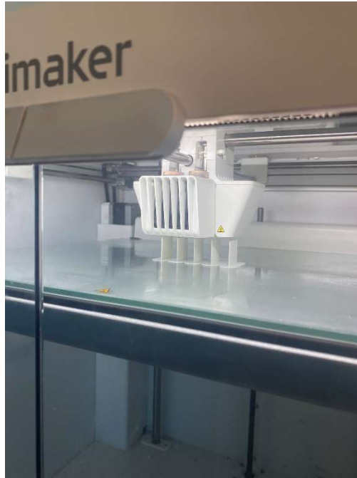
Figura 45. Proceso impresión de la prueba de espesor. (Elaboración propia, 2025)
