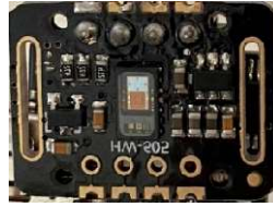
Figura 51. Sensor medidor de pulso MAX30102. (Elaboración propia, 2025)
