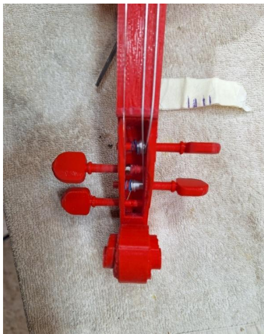
Figura 70. Colocación de las clavijas
