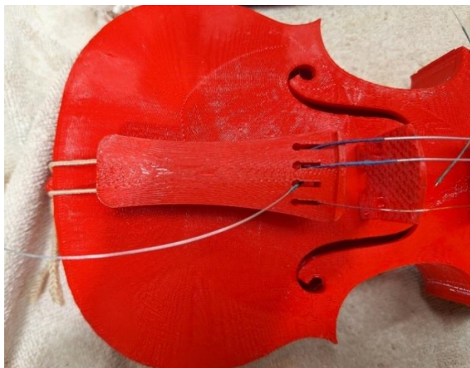
Figura 69. Colocación del cordal
