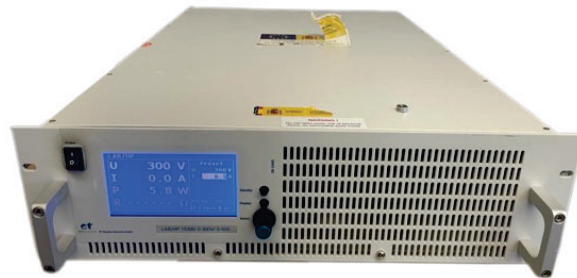
Figura 5.5: Bus de continua de la bancada modelo LB/HP 15300.
