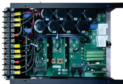
Figura 5.4: Convertidor trifásico Semikron con tecnología IGBT en sus transistores.
