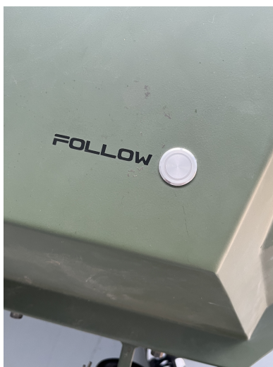
Figura 2.15: Botón follow me en la parte delantera del vehículo.
