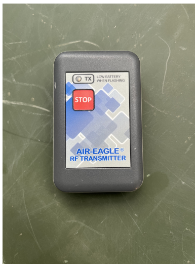
Figura 2.7: Botón de parada de emergencia en el mando inalámbrico.
