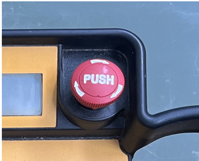
Figura 5.17: Botón EStop del control remoto.
