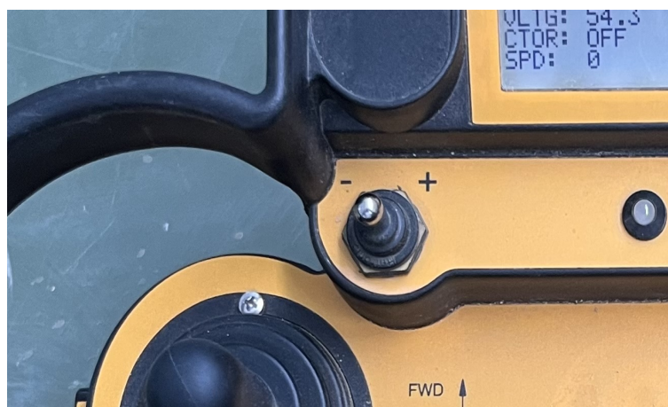
Figura 5.16: Botón para las señales DK13 y DK14 encargado de subir y bajar la marcha.
