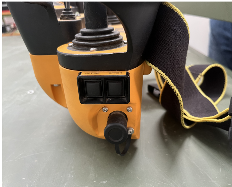
Figura 5.15: Botones para las señales DK11 y DK12 encargados de la activación de los contactores.
