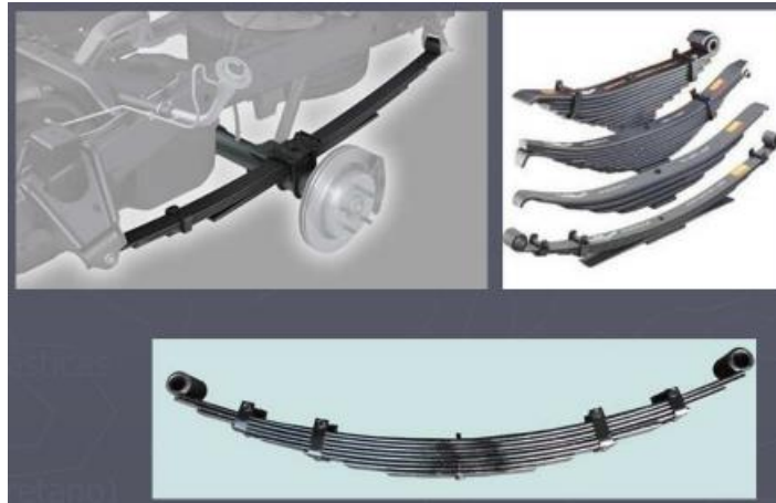
Ilustración 73 : Ejemplo muelles a flexión. Fuente: Universidad de Málaga
