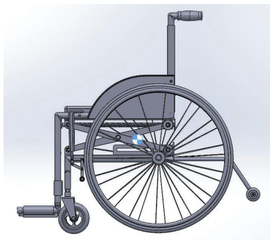
Figura 45: Centro de gravedad de la silla de ruedas sin elevar, vista lateral (Elaboración propia).
