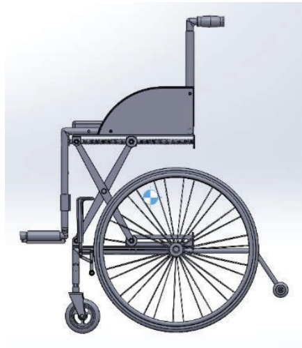
Figura 47: Centro de gravedad de la silla de ruedas elevada, vista lateral (Elaboración propia).
