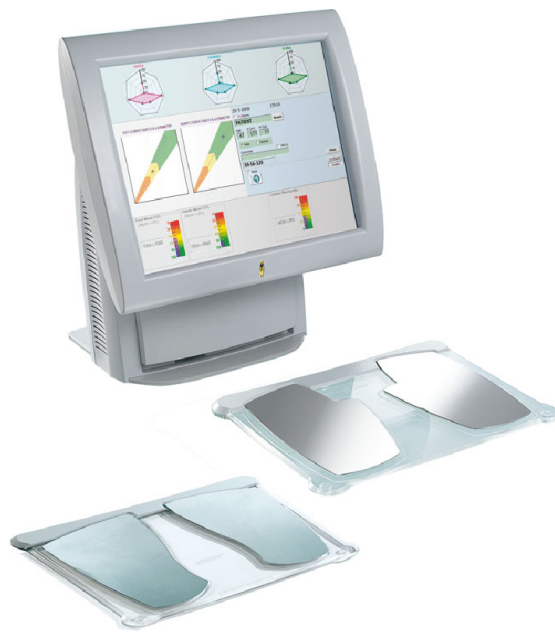
Figura 14: Presentación típica del instrumento Sudoscan®, con dos plataformas para manos y pies y un monitor para el procesamiento de la información recogida (Zhu et al., 2016)
