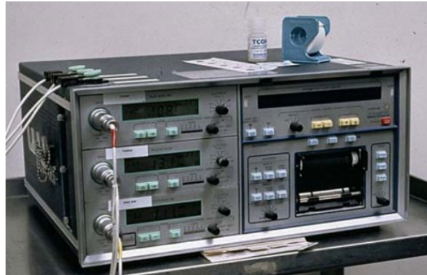
Figura 16: Monitor Novamatrix 800® para la medición de la TcPO2 con tres electrodos de tipo Clark. Extraído de (Ballard, 2007).
