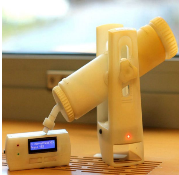
Figura 13: Aspecto visual de Nervecheck® cuyas dimensiones son 9,5 cm × 6,1 cm × 23,6 cm y su peso es de 325g (Ponirakis et al., 2016).
