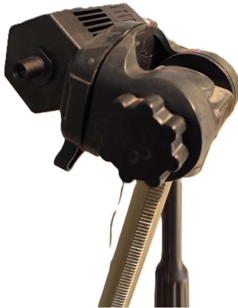
Figura 3.5: Láser usado en el estudio. Microvec SM-SEMI-1W
