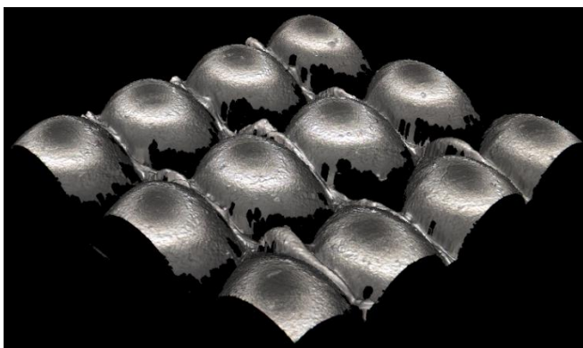
Figura 48. Imágenes de la superficie y la rugosidad de la probeta sin mecanizar.
