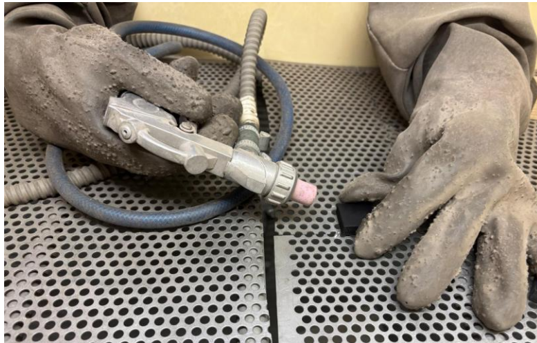
Figura 34. Colocación para el proceso de mecanizado por chorro abrasivo.
