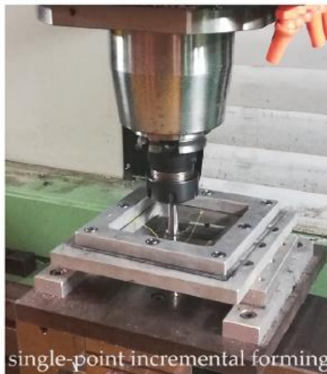
Figura 15. Aplicación del proceso de SPIF a una lámina polimérica (Formisano y Durante, 2024).
