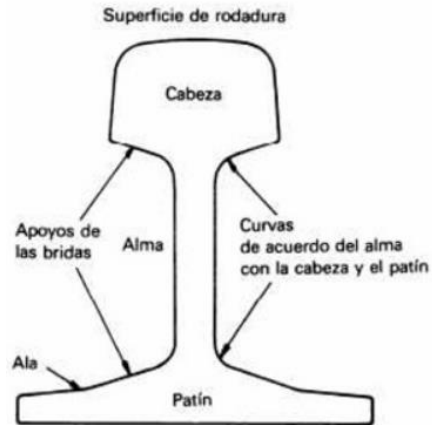
Figura 9. Partes del carril [17]
