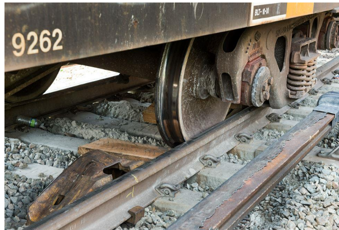
Figura 3. Encarriladores tipo calzos [12]
