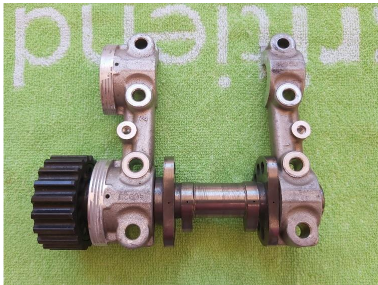
Imagen 19. Ensamble de sujeción superior de los árboles de levas y eje 1. Fuente: Propia
