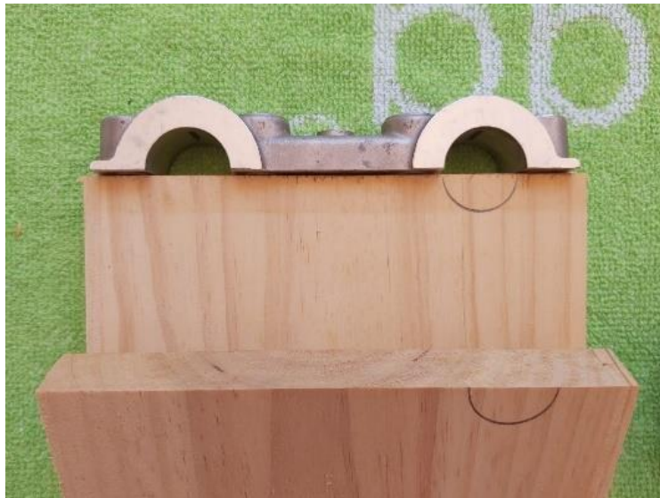
Imagen 8. Vista frontal del ensamblaje de la sujeción superior de los árboles de levas y estructura. Fuente: Propia
