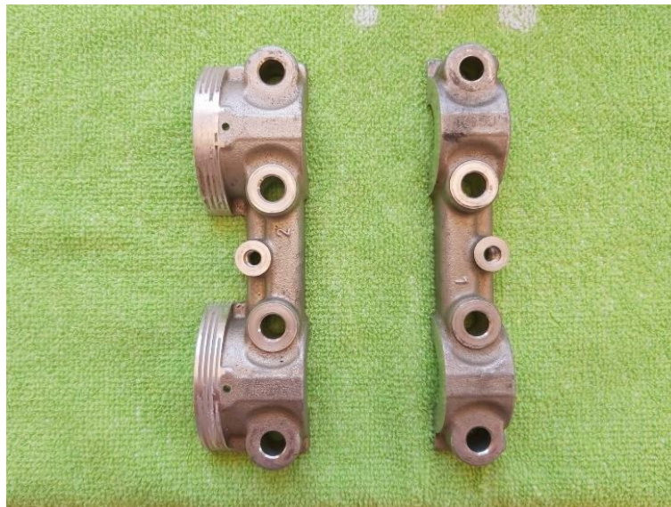
Imagen 2. Planta superior de la sujeción superior de los árboles de levas. Fuente: Propia
