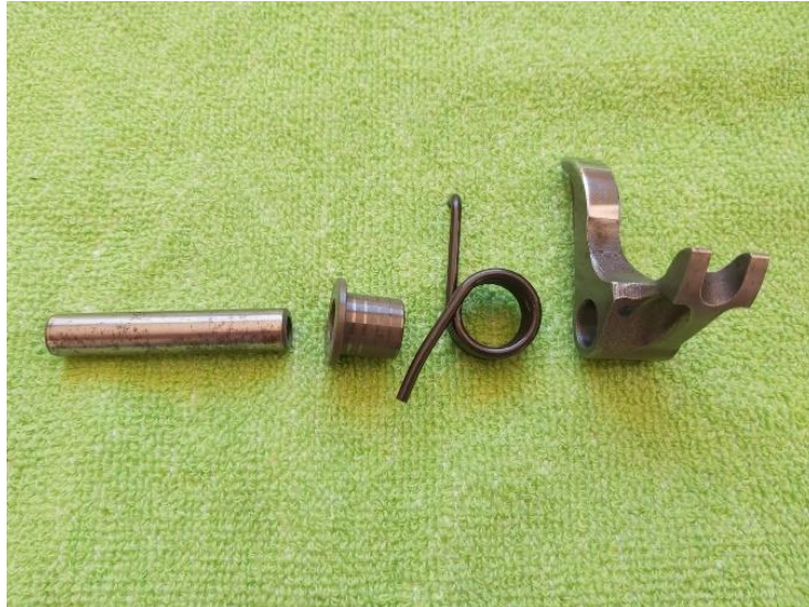
Imagen 4. Eje 1, balancín 1, resorte y sujeción de resorte. Fuente: Propia
