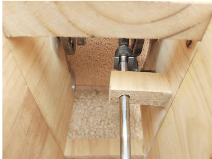
Imagen 25. Vista interior: Contacto del Balancín 1 a la válvula. Fuente: Propia
