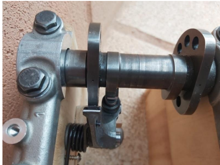
Imagen 29. Vista interior: Contacto de leva 1 con el balancín 1. Fuente: Propia
