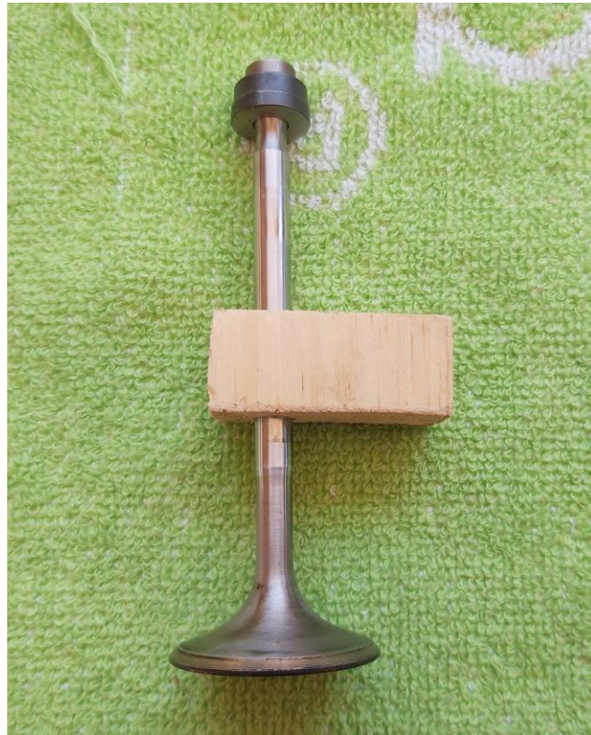
Imagen 16. Vista frontal de Válvula con soporte. Fuente: Propia
