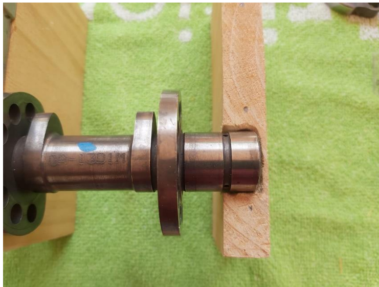
Imagen 10. Vista de los rebajes realizados. Fuente: Propia
