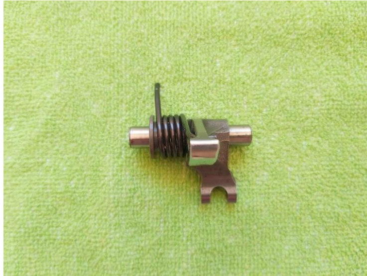
Imagen 14. Vista en planta superior del conjunto de balancín 1. Fuente: Propia
