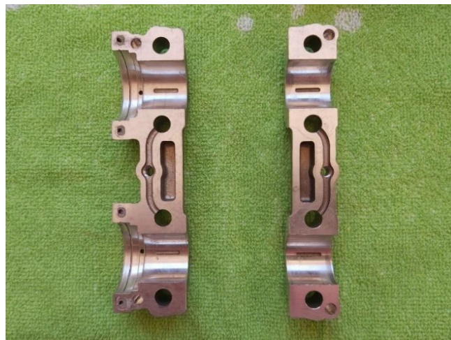
Imagen 1. Planta inferior de la sujeción superior de los árboles de levas. Fuente: Propia
