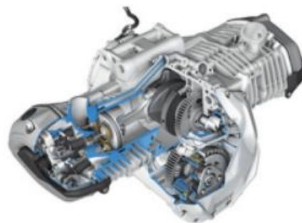
SISTEMA DE ENFRIAMIENTO POR AIRE
