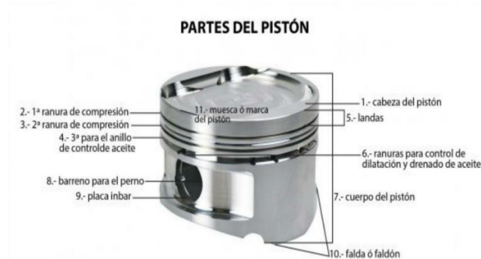
Figura 24. Partes de un pistón. Fuente: Como Funciona [21]
