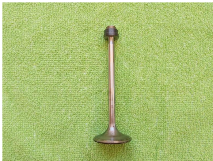
Imagen 17. Ensamble de válvula y Taqué. Fuente: Propia
