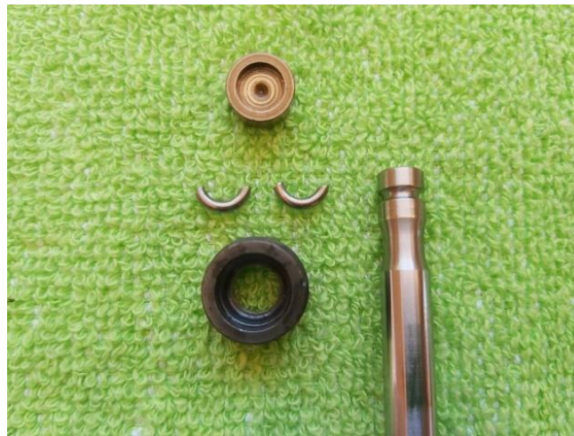
Imagen 6. Vista en detalle de la parte superior de la válvula y Taqué. Fuente: Propia
