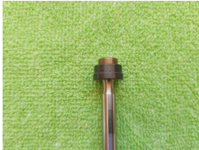
Imagen 18. Vista en detalle del ensamblaje de válvula y Taqué. Fuente: Propia
