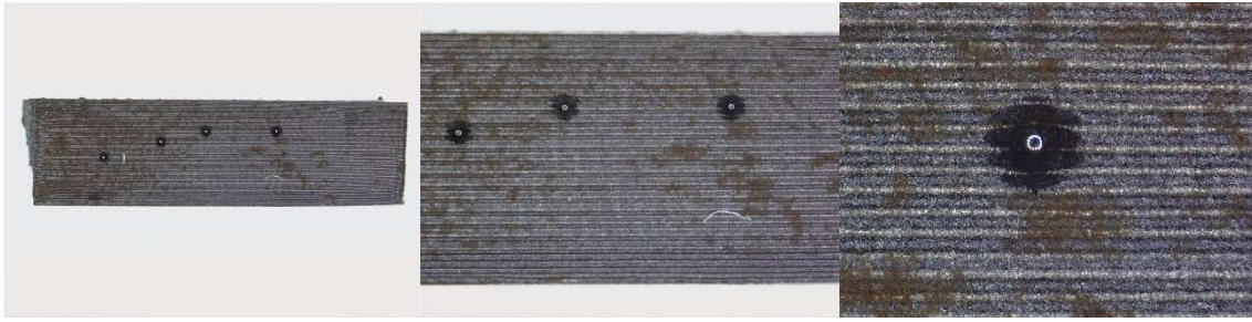
Figura 64. Cavidades generadas por el ensayo de dureza en probetas de A2 con relleno sólido (Elaboración propia).
