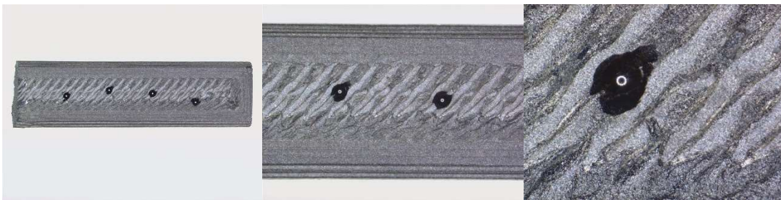
Figura 65. Cavidades generadas por el ensayo de dureza en probetas de H13 con relleno sólido (Elaboración propia).
