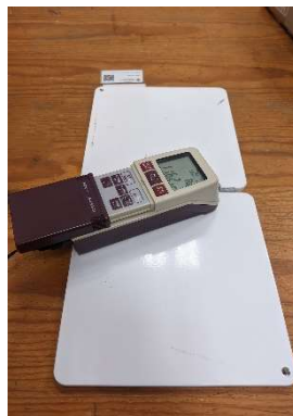
Figura 28. Medida de rugosidad superficial (Elaboración propia).
