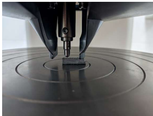
Figura 40. Ensayo de dureza (Elaboración propia).
