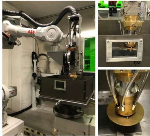
Figura 10. Robot láser ABB con 6 cabezales de boquilla utilizado para realizar el proceso DED (Morales et al., 2023).
