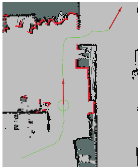
Figura 21. Trayectoria trazada por el planificador global (línea verde)
