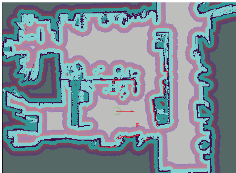
Figura 17. Mapa de coste global del entorno usado para la simulación
