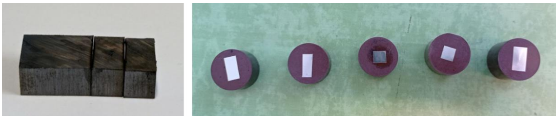
Figura 28: imágenes de a) probeta CT cortada para ser preparada, b) probetas encapsuladas.
