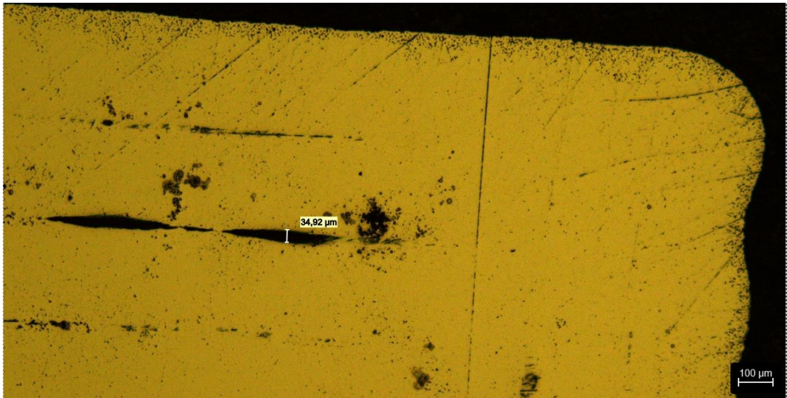
Figura 49: micrografía de la probeta de fatiga, aquí se pueden ver claramente las capas formadas por el filamento metálico y hay algo de separación entre ellas.
