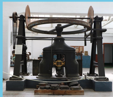
Prensa de husillo a fricción Delalande (1808) Museo de las Reales Fábricas de San Juan de Alcaraz de Riópar (Albacete)
