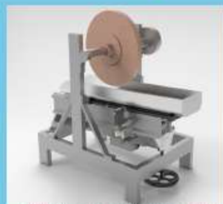
Rectificadora de superficies planas "Darling" (patentada en 1853)
