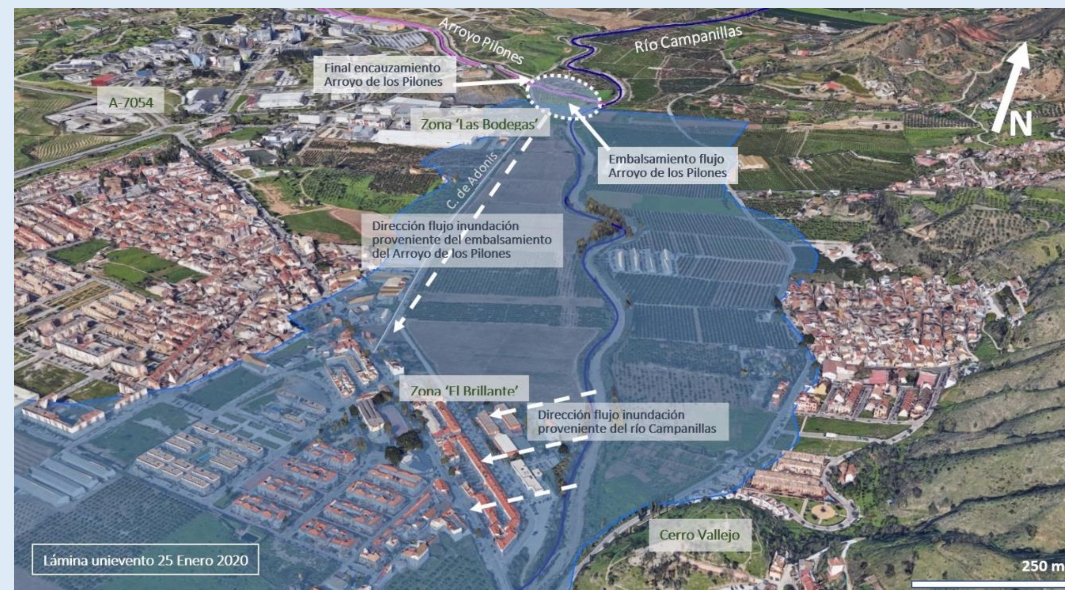
Figura 2. Recreación de la lámina unievento con direcciones de flujos de inundación
