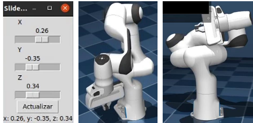
Figura 4.6: Imágenes del vídeo de reach4 en modo TEST_GUI. La segunda captura es el efector final estático en el punto de la primera captura. La tercera muestra la colisión del manipulador consigo mismo.
