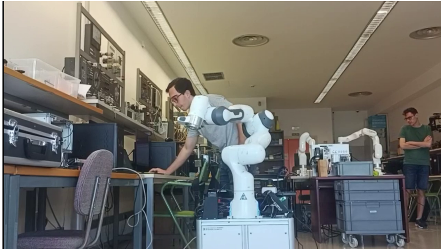
Figura 4.23: Manipulador Franka Emika Panda con el efector final en el punto objetivo, situado a la izquierda. La orientación, aunque es aproximadamente vertical, tiene un error visiblemente mayor a la posición.
