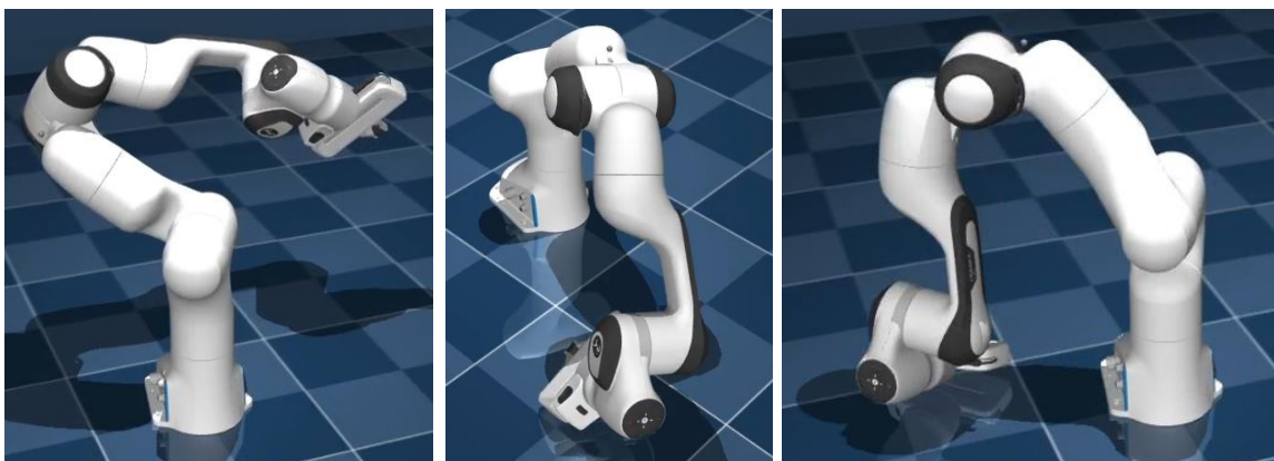
Figura 4.9: Imágenes del vídeo de reach5_1 en modo TEST_GUI. La captura de la izquierda muestra el efector final estable en un punto. Las capturas del centro y la derecha muestran colisiones del efector final con el suelo.
