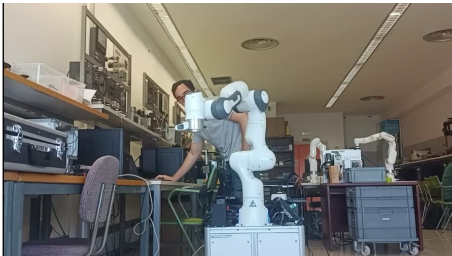
Figura 4.20: Manipulador Franka Emika Panda con el efector final en el punto objetivo, situado a la izquierda.
