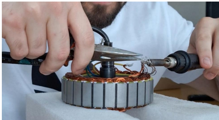
Figura 15. Proceso de desestañado con el soldador. Fuente: Elaboración Propia
