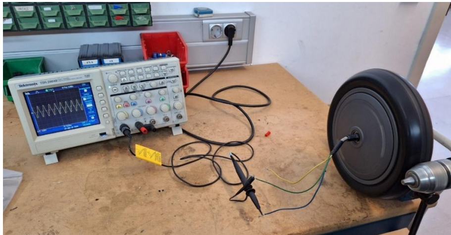
Figura 27. Simulación de viento extremo con el taladro. Fuente: Elaboración Propia
