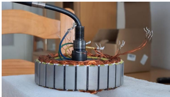
Figura 16. Terminales libres. Fuente: Elaboración Propia
