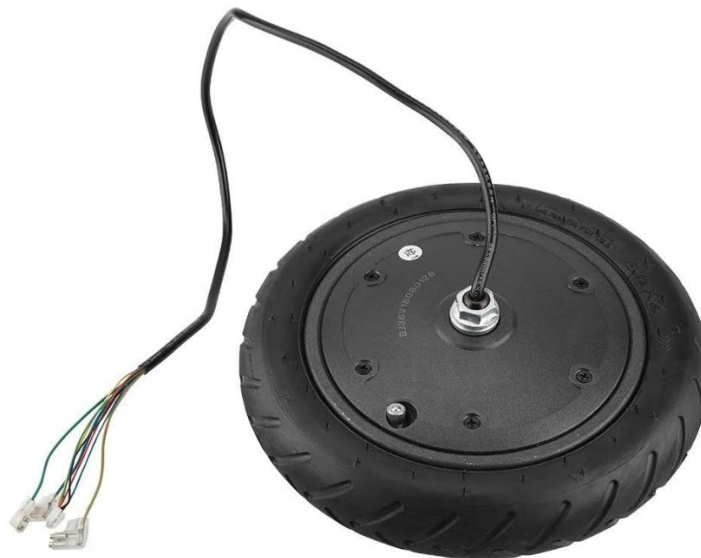
Figura 1. Motor síncrono trifásico de imanes permanentes utilizado. Fuente: AliExpress ( www.aliexpress.com )
