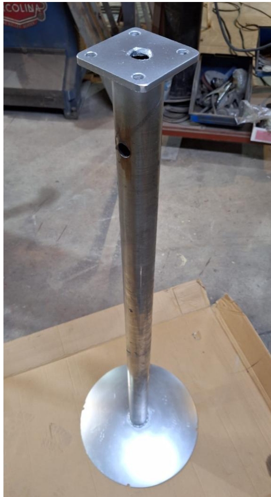
Figura 33. Soporte vertical terminado. Fuente: Elaboración Propia
