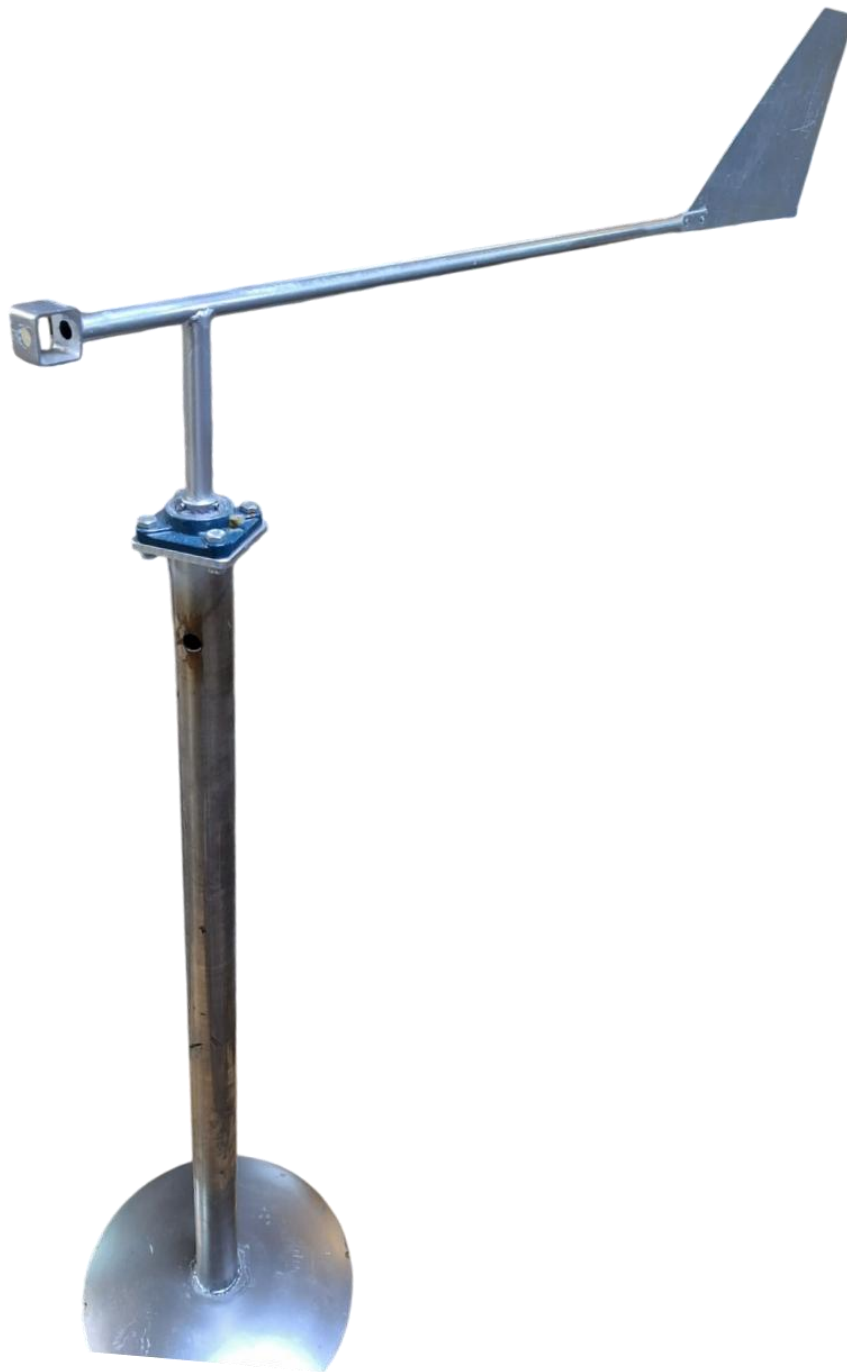
Figura 37. Estructura completa montada, a falta de acoplar el generador con las palas. Fuente: Elaboración Propia
