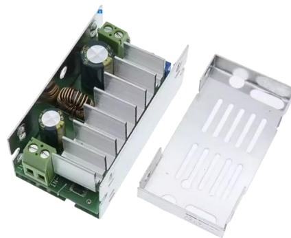
Figura 3. Regulador de voltaje DC-DC de 400W. Fuente: AliExpress (www.aliexpress.com)
