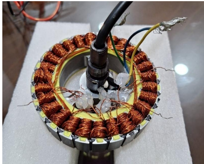
Figura 18. Empalmes aislados con silicona. Fuente: Elaboración Propia
