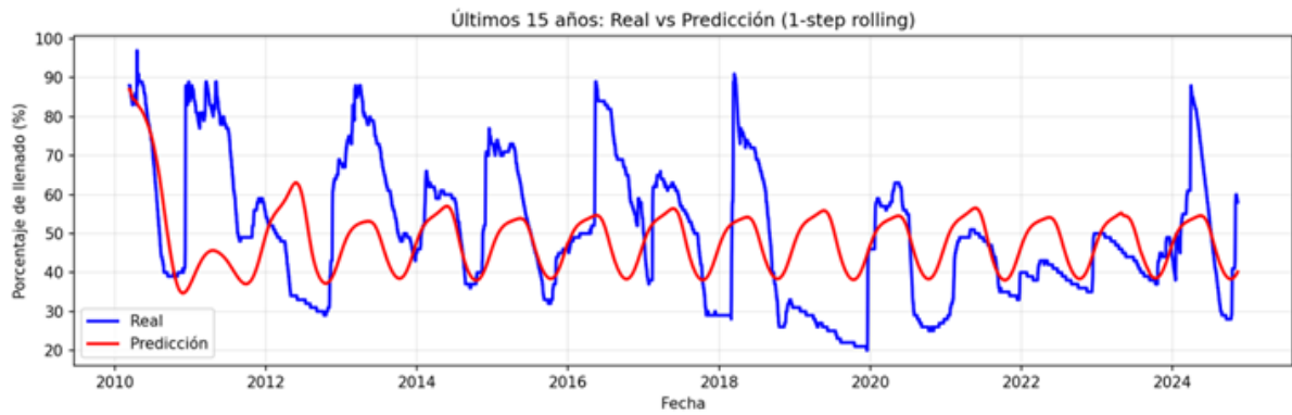
Figura 125: Evolución del porcentaje de llenado en los últimos 15 años para el embalse de Cala (Entrenamiento residual y solo lags)
