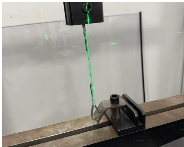
Figura 52. Montaje del ensayo de conservación del ángulo de la pletina
