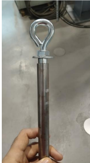
Figura 45. Cáncamo instalado en la barra
