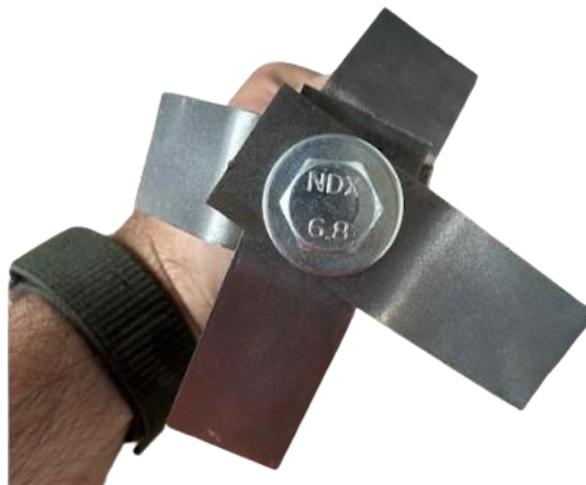
Figura 31. Nodo pletinas construido en el laboratorio
