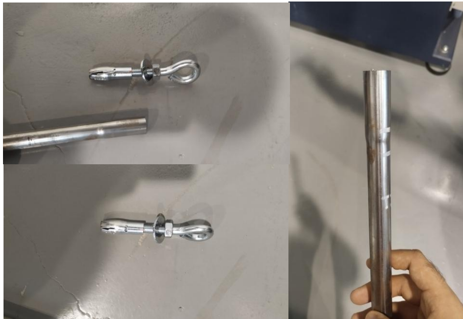
Figura 48. Cáncamo y barra tras ensayo
