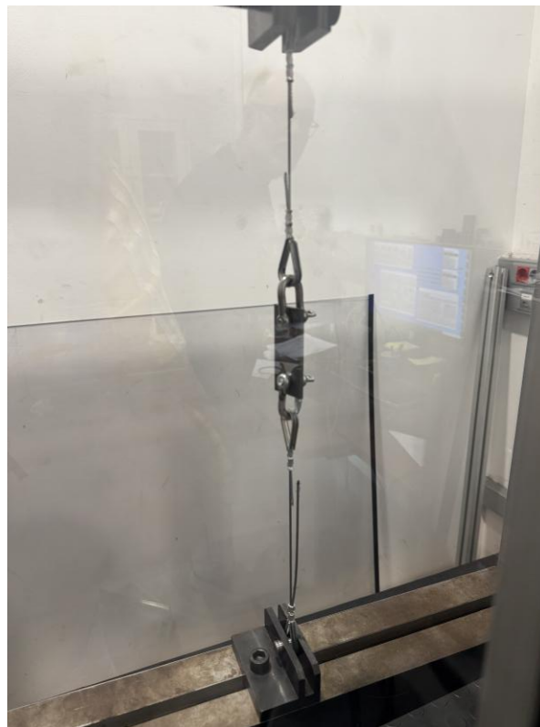
Figura 49. Montaje del ensayo de tracción a la pletina
