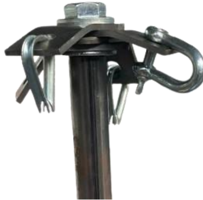
Figura 30. Nodo pletinas construido en el laboratorio
