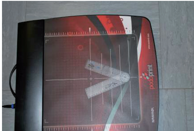
Figura 30: plataforma de presiones con goniómetro a 45° para colocación del sujeto
