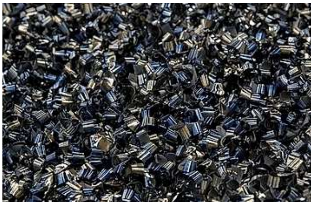
Figura 2.5- Ejemplo de viruta fragmentada [11].
