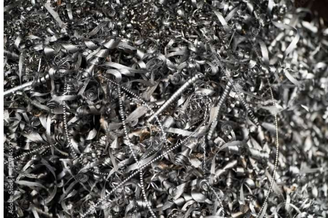
Figura 2.7- Ejemplo de viruta irregular [13].
