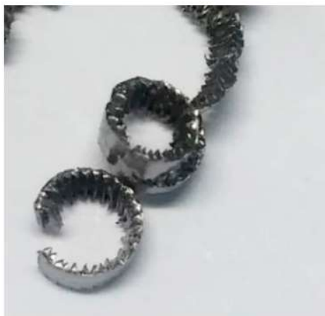
Figura 2.10- Macro viruta de Ti6Al4V obtenida a v_c = 30 \text{ m/min} y f = 0.30 \text{ mm/r} [1].
