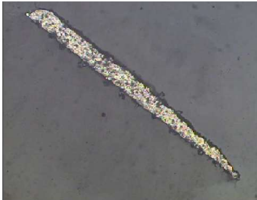
Figura 5.20- Comparación de viruta transversal de Al mecanizada a bajo y alto avance.
