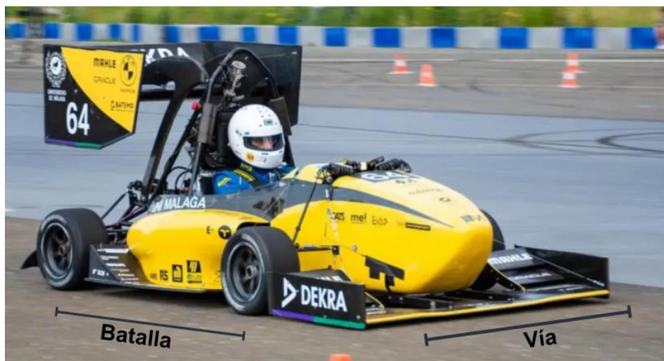
Figura 5: Parámetros geométricos sobre el MA23RT
