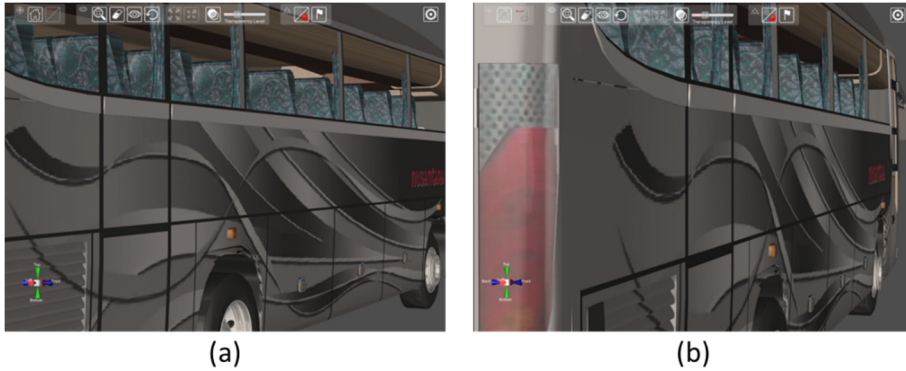
Figura 61. Vista del modelo del autobús cuando la cámara está situada muy cerca del objeto y próxima al extremo de la elipse de traslación. En (a) se muestra el resultado cuando se adopta la solución presentada en la ecuación (26), y en (b) cuando se modifica para haciendo que E_c = \min[e_x, e_z] .
