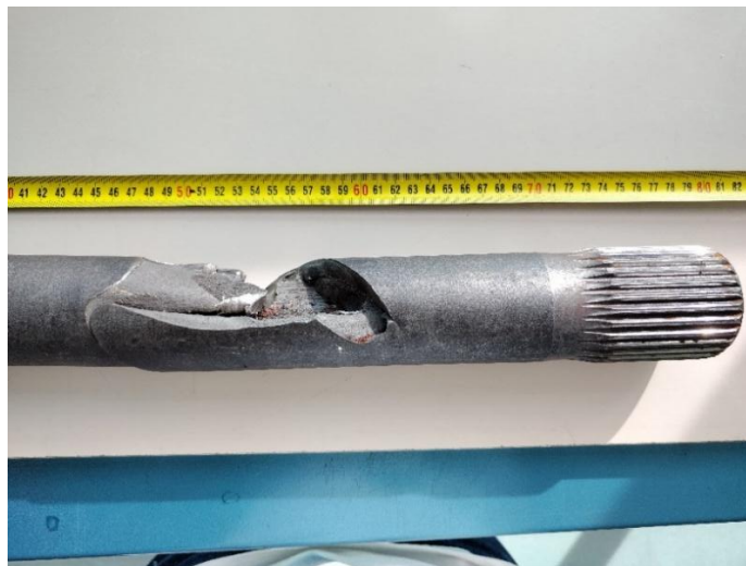
Figura 14. Zona de ruptura.
