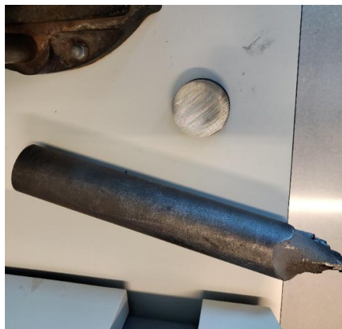
Figura 23. Probeta junto la pieza inicial.
