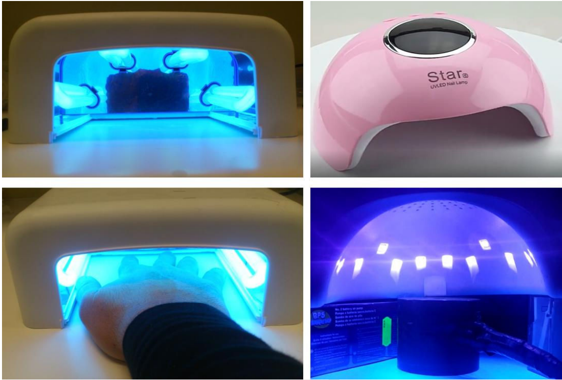
Figura 1. Imágenes de las lámparas polimerizadoras utilizadas en el presente estudio. Disposición de los tubos fluorescentes y leds. En la izquierda, imagen de la mano colocada para medir distancia de medida (8 cm). En la imagen derecha se observa el punto de medida donde se ha colocado el sensor de medida de la radiación espectral.
