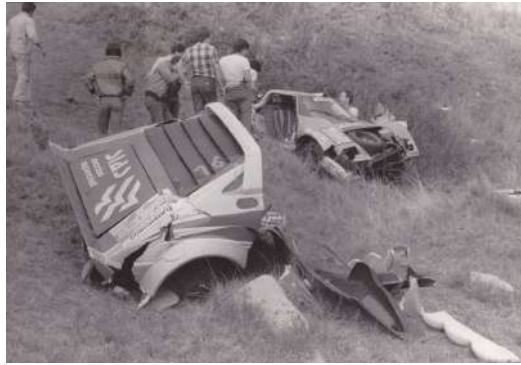
Ilustración 99. Forma de fractura de la carrocería del modelo original.
