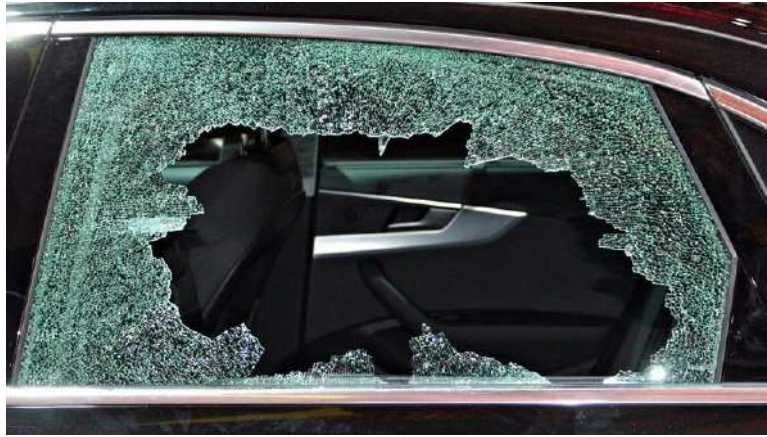
Ilustración 103. Comportamiento de una ventanilla frente a colisión.
