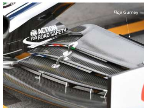
Ilustración 28. Aplicación de los Gurney Flaps en la F1.
