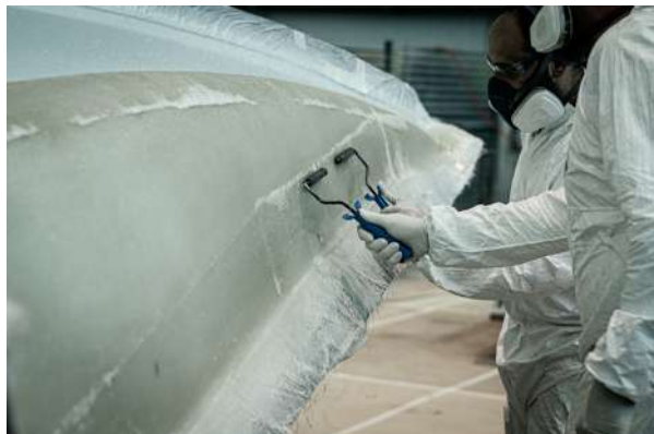
Ilustración 101. Formación de la fibra de vidrio.
