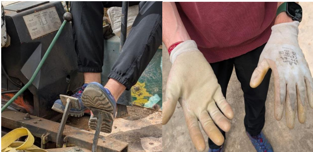
Ilustración 65. Equipos de protección individual dañados
