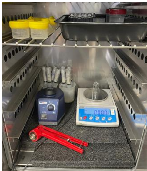
Figura 2.2. Equipo y material usado en la preparación de pastas para calorimetría (dentro de la estufa a 40\text{ }^{\circ}\text{C} \pm 1 ).
