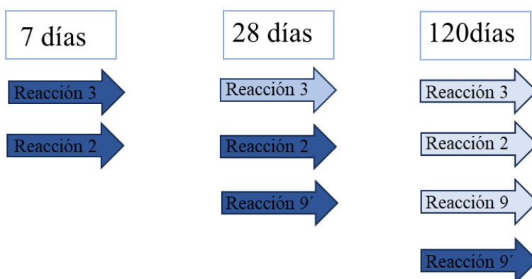
Figura 4.11. Representación de los posibles equilibrios en la pasta St-BYF_wc04_01SP_025B 2 O 3 a lo largo de los 120 días para justificar la reactividad de la ferrita, stratlingita y katoita. Las tonalidades indican el predominio de unas reacciones frente a otras, siendo las de tonalidades oscuras las mayoritarias y las tonalidades claras las minoritarias. [Elaboración propia].
