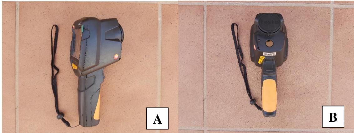
Figura 27. (A) Cámara termográfica de perfil. (B) Cámara termográfica de frente. Fuente: Original.
