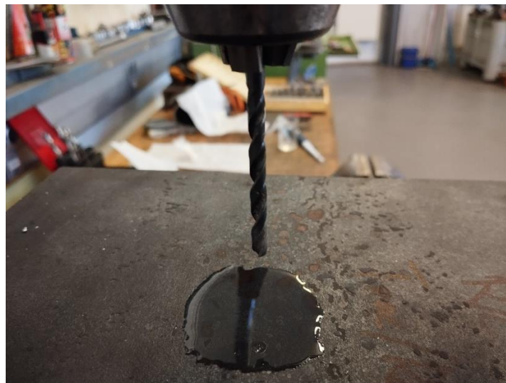
Figura 44. Fluido depositado sobre la placa de acero. Fuente: Original.
