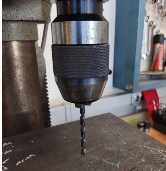
Figura 43. Broca colocada en el taladro. Fuente: Original.
