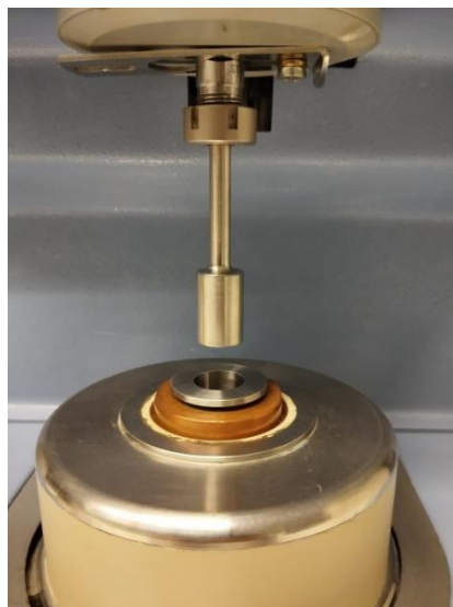
Figura 39. Disposición de los cilindros en el reómetro Gemini. Fuente: Original.
