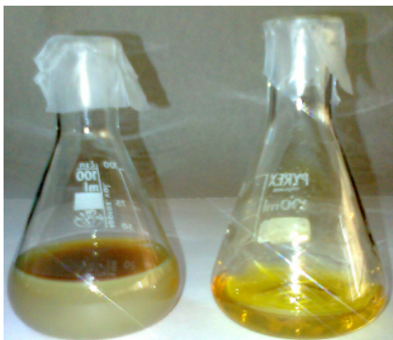
Figura III.1. Disoluciones coloidales de plata obtenidas con hidroxilamina (izquierda) y borohidruro sódico (derecha).
