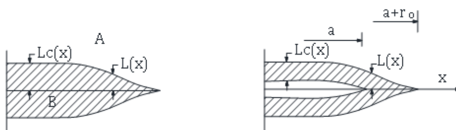
Fig. 2.12. Zonas elástica (A) y plástica (B) consideradas en el modelo..
