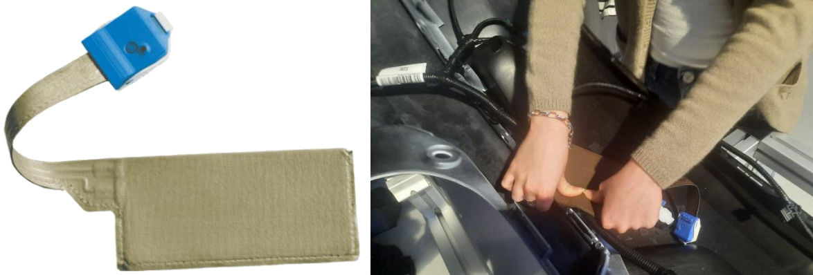
Ilustración 22: Sensor de fuerza Loadpad y un participante usándolo. Fuente: Elaboración Propia.
