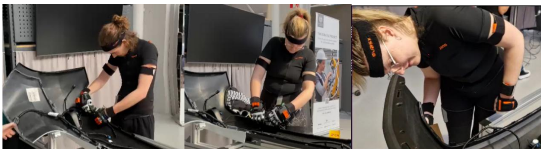
Ilustración 16: Participantes Casos 2 y 4 comprobando si el clip está correctamente colocado para liberar la fuerza. Fuente: Elaboración Propia.
