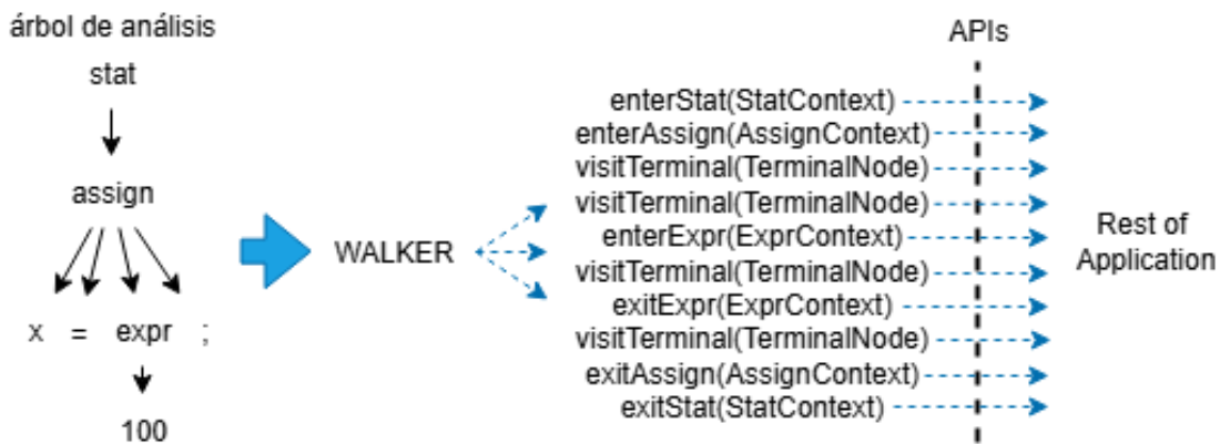
Figura 3.2 Funcionamiento del listener de ANTLR4
