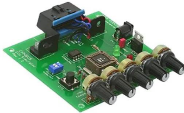
Figura 10. Placa emuladora CAN BUS ECU simulator v2.0 de la marca OZEN ELEKTRONIK.
