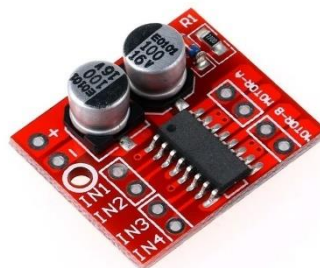
Figura 17.- Imagen de un módulo controlador de motor, modelo Mini L298N.
