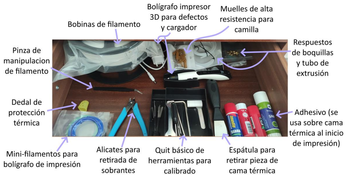
Figura 51. Materiales accesorios al proceso de impresión 3D. Se puede ver su descripción en la propia imagen. Sólo cabría destacar que el bolígrafo 3D funciona igual que una impresora 3D manual.
