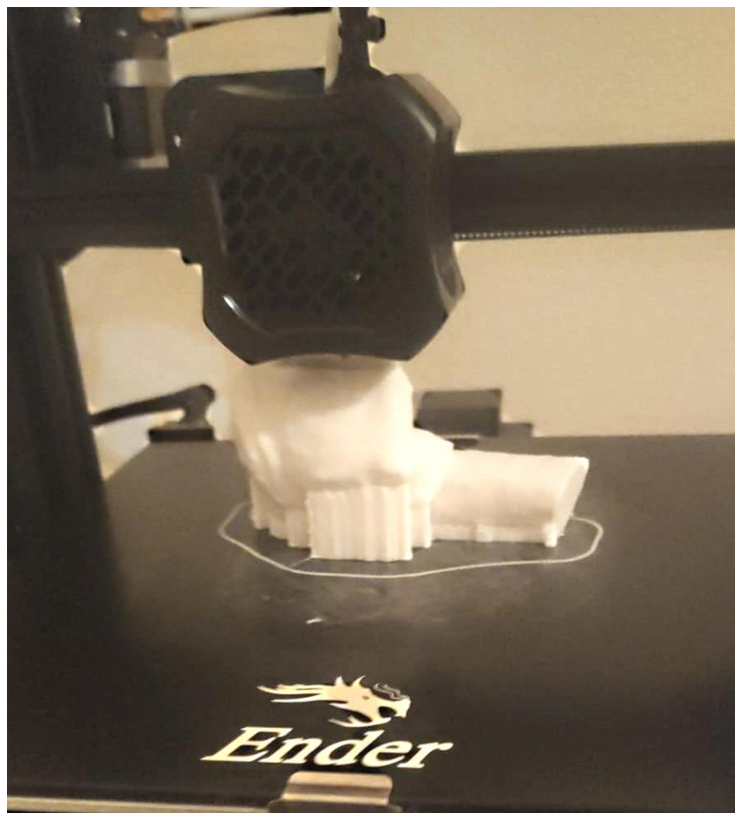
Figura 52. Proceso de impresión de uno de nuestros modelos. Se puede apreciar un primer círculo externo de calibrado y los soportes en la zona inferior del eje Z, que después se retirarán fácilmente con los alicates.
