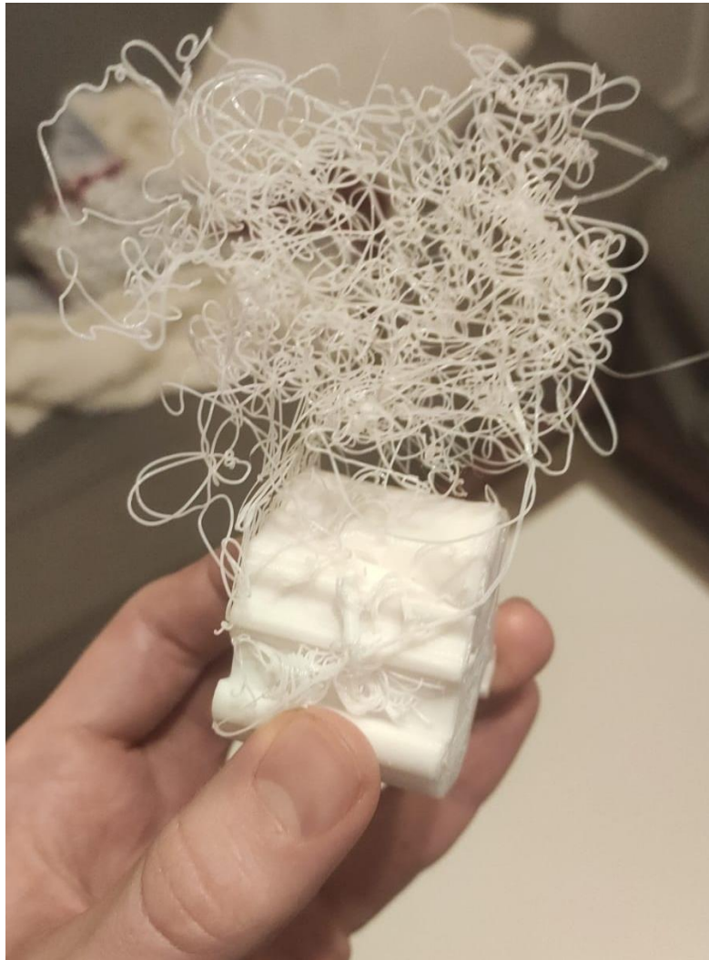
Figura 50. Fallo crítico de impresión durante la preparación de los modelos humerales. Fallo “en spaghetti”, consistente en una pérdida del “hilo de impresión”, dejándose de imprimir sobre el riel que marcan las capas previas y empezando a imprimir al aire, creándose una maraña. En este caso, bastó con ajustar el calibrado de la cama y añadir más adhesivo a la misma para conseguir que, al siguiente intento, el modelo se imprimiera con éxito.
