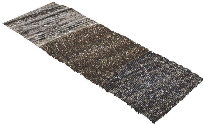
Figura 24, pieza de titanio sin texturizar (franja izquierda), texturizada una vez (franja central) y texturizada dos veces (franja derecha)
