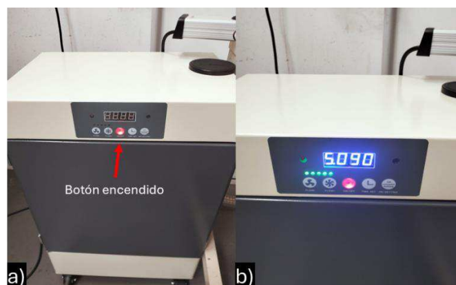
Figura 37, extractor de gases. a) Botón de encendido; b) Extractor encendido
