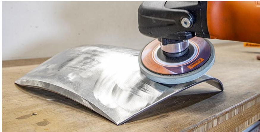
Figura 17, pulido mecánico mediante fijación a disco [32].
