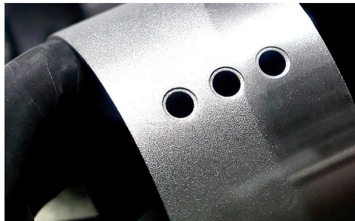
Figura 16, comparación superficie granallada y sin granallar [31].
