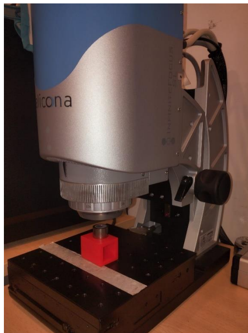
Figura 42, colocación de la pieza en la base del microscopio confocal
