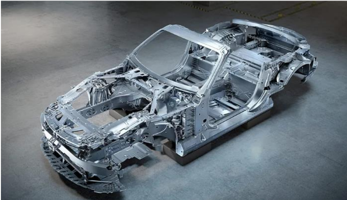
Imagen 93: Estructura reforzada de R232 SL 63 S E 4MATIC+
