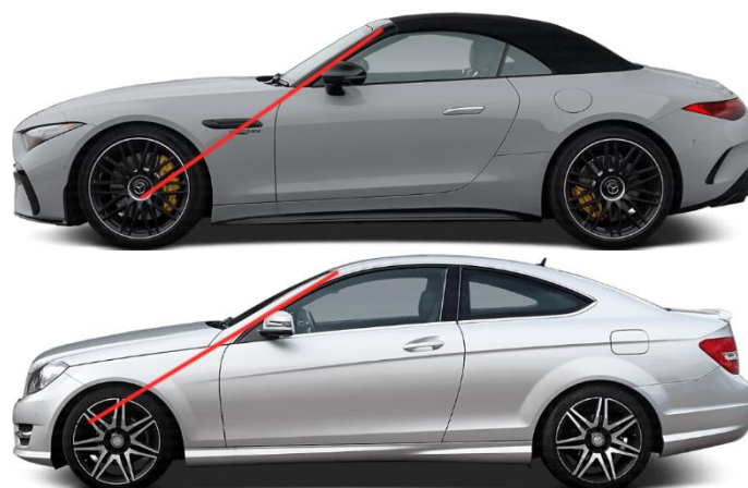
Imagen 8: Inclinación del Pilar A
