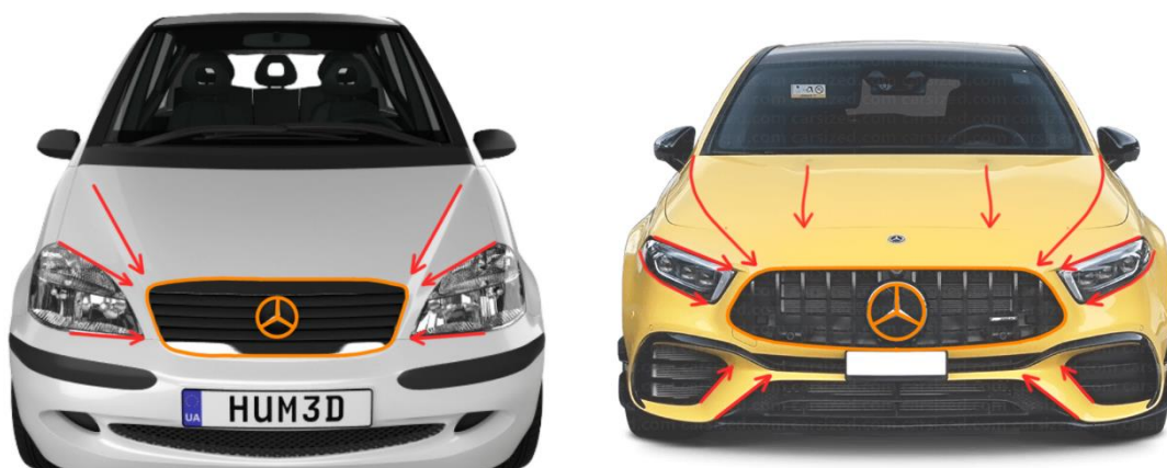
Imagen 13: Convergencia de las líneas hacia la toma del aire
