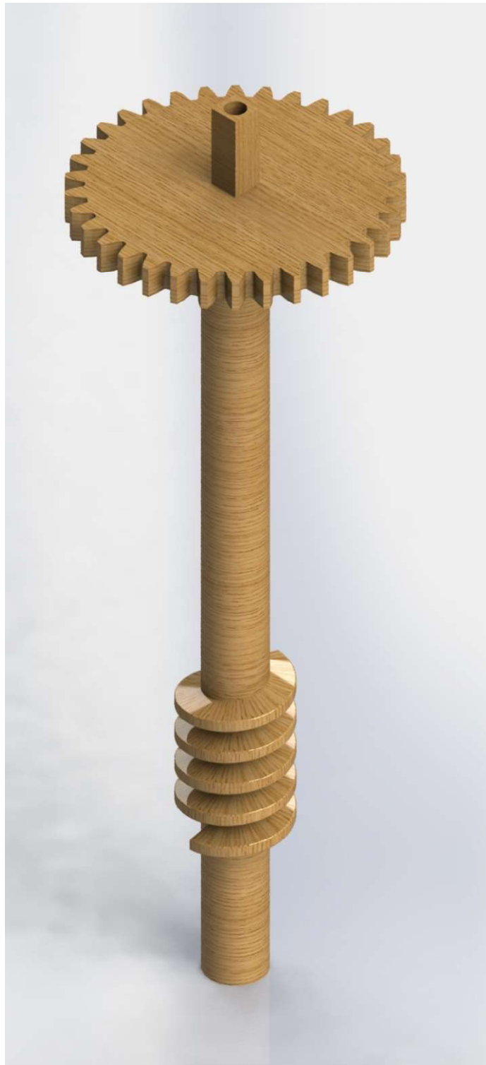
ANEXO I. Figura 12. Transmisión principal. Elaboración propia mediante la herramienta PhotoView 360 de SOLIDWORKS 2022.
