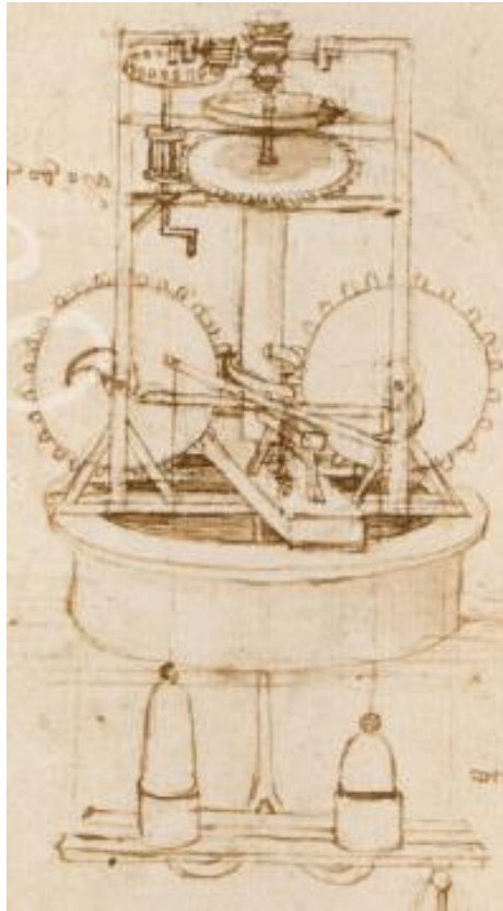
Manuscrito original de la máquina de elevación de agua en el Códice Atlántico f, 1069r
