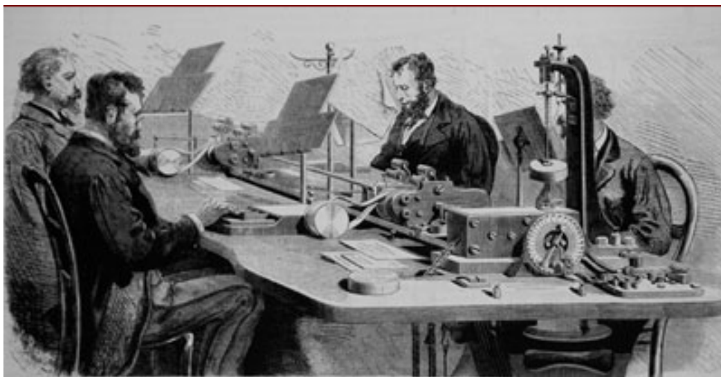
Ilustración 27. "París. Telégrafo múltiple Mr. Meyer: gabinete de los aparatos de transmisión". Dibujo: V. Rose
