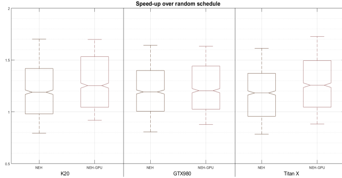
Figura 3.8: Diagrama de cajas de speedup para las heurísticas NEH y NEH-GPU sobre la planificación aleatoria cuando se cargan 64 tareas en K20c, GTX 980 y Titan X.
