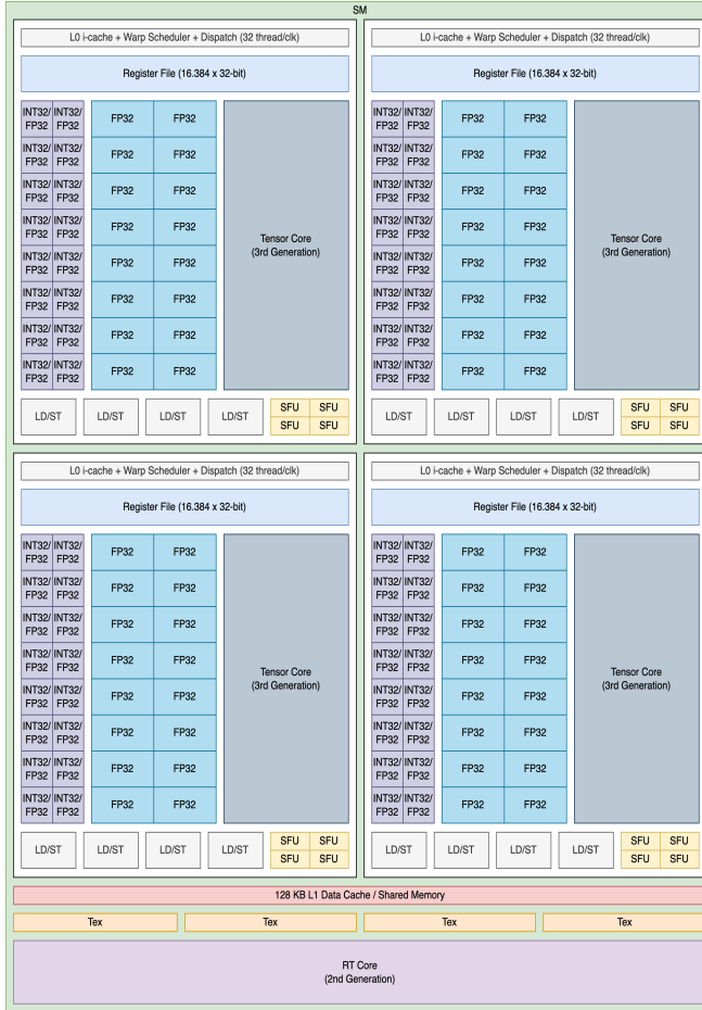
Figura 2.10: SM de la arquitectura Ampere de NVIDIA.
