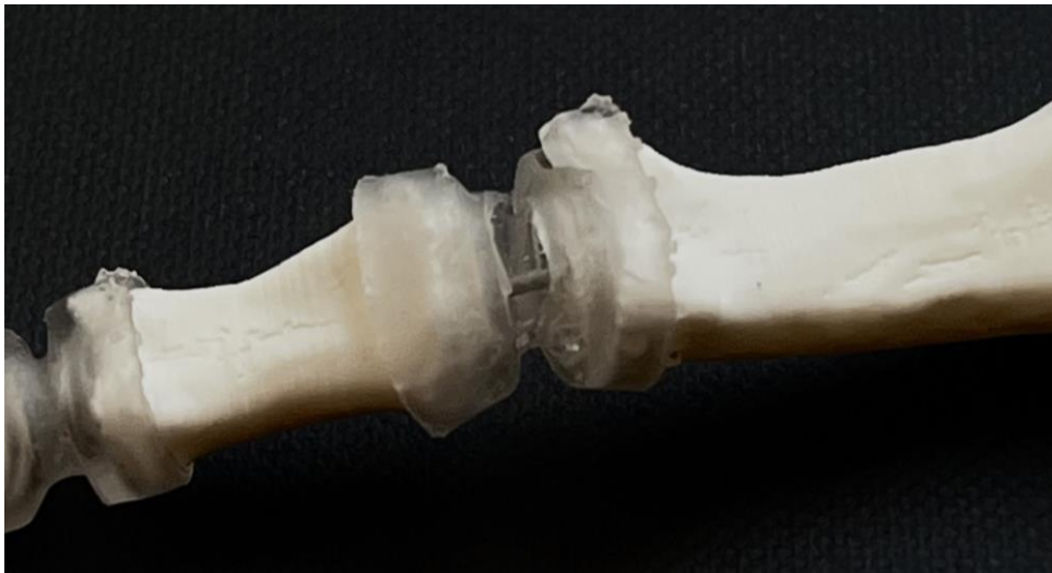
Figura 57: Fisura en prueba de articulación con eje hiperbólico Fuente: propia
