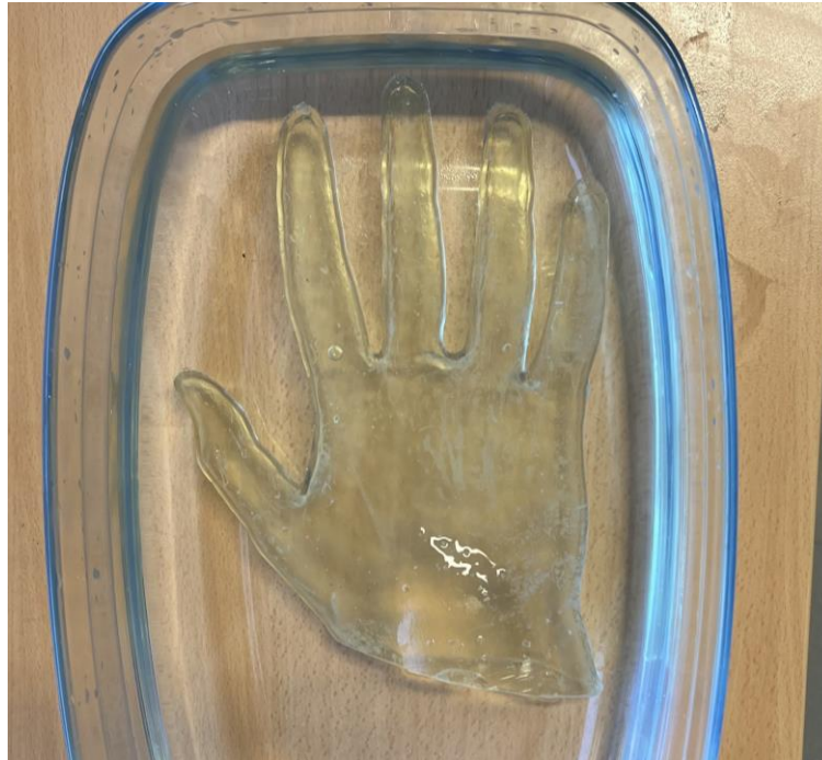
Figura 80: Impresión tras eliminar los soportes Fuente: propia
