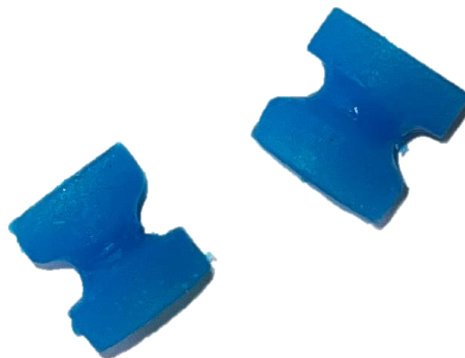
Figura 71: Articulación de silicona final Fuente: propia
